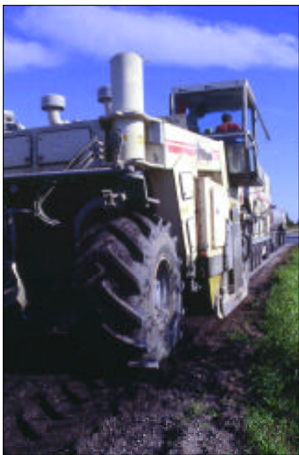
Il treno composto dalla WR2500 e dalla WM1000. A destra: le prove di portanza sono state eseguite con sistema dinamico e peso a caduta.
