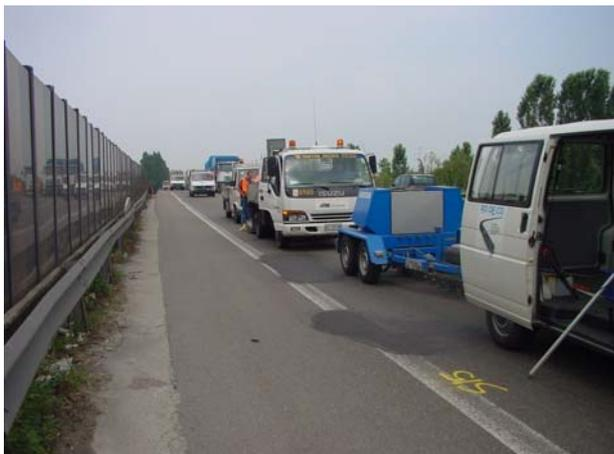
*Il treno dei mezzi approntato per l'esecuzione delle indagini preliminari: in primo piano l'HWD, seguito da GPR e carotatrice*
